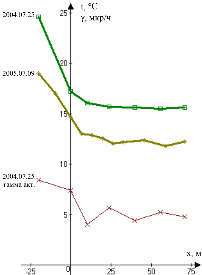
Рис. 5. Изменение температуры и гамма активности по длине штольни входа 28
